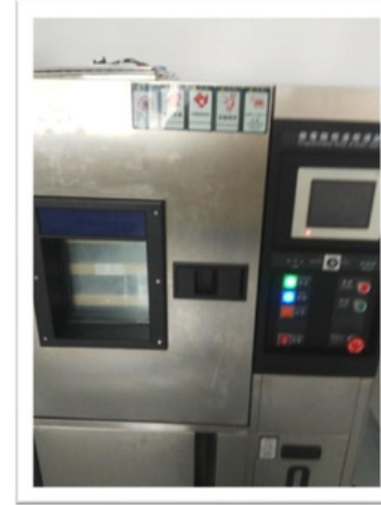
Prueba de humedad
